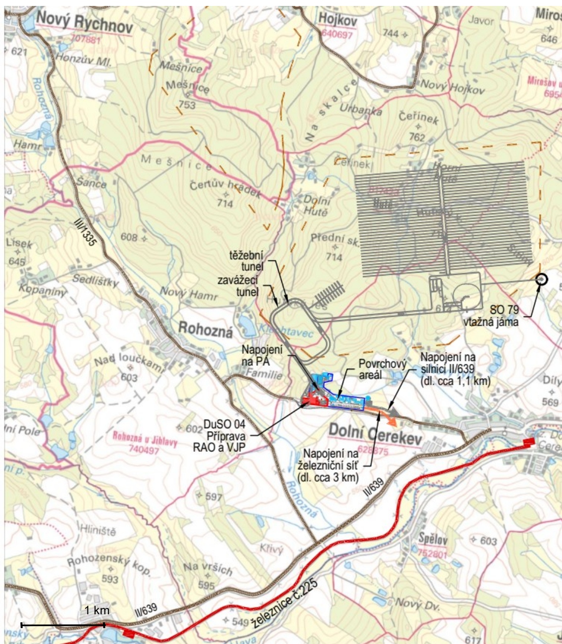
Obr. 40 Schéma napojení preferovaného umístění PA na dopravní infrastrukturu – lokalita Hrádek
