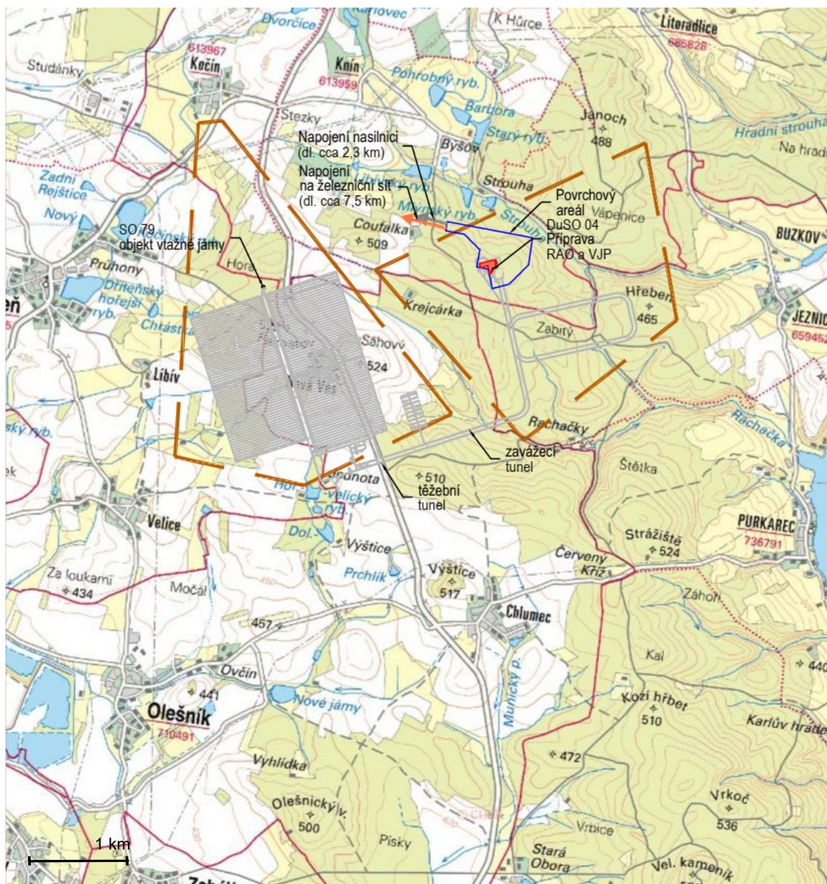
Obr. 66 Schéma napojení PA na dopravní infrastrukturu – lokalita Janoch
