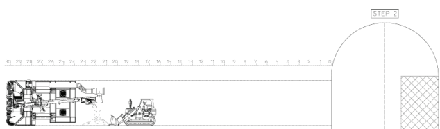
↑ Vyražení úvodní části ukládacího vrtu
