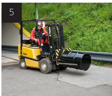
5 přemístění sudů do podzemních prostor úložiště
