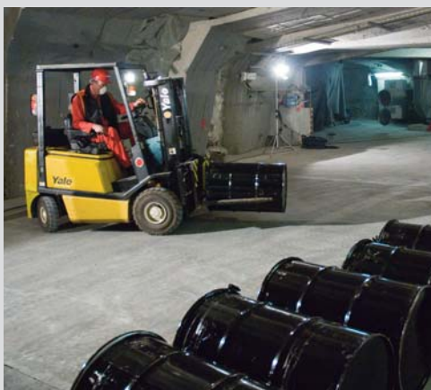
Manipulace a umístění sudů s radioaktivním odpadem do úložné komory.
