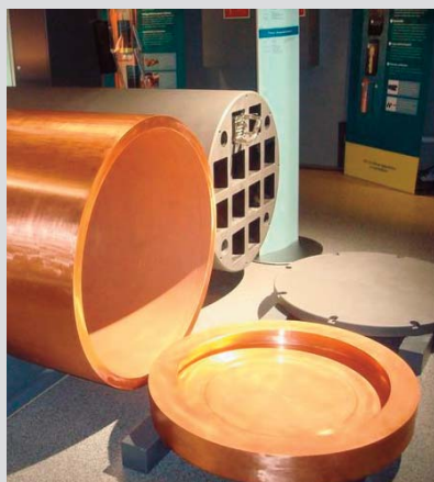
Finský úložný kontejner pro 12 palivových článků.
