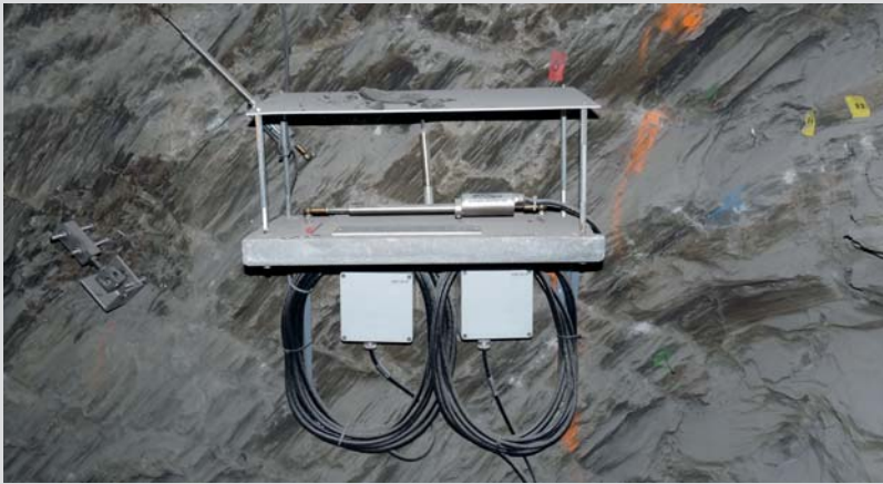
Podzemní laboratoř Mont Terri - měření napětí na puklinách.
