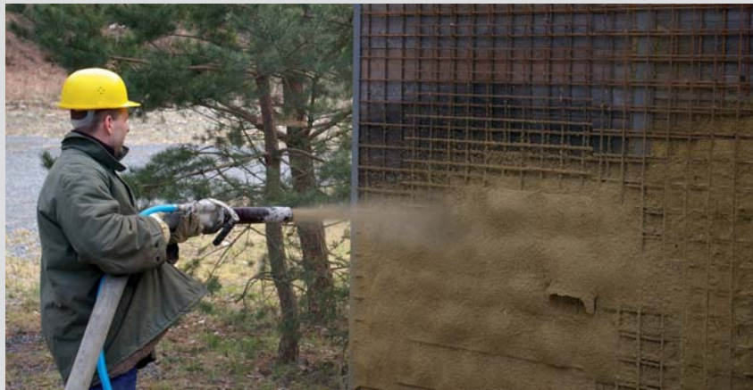
Eperimentální výzkum technologie stříkaného backfillu. Pracoviště UEF Josef ČVUT, fakulty stavební. Ukázka nástřiku bentonitové směsi na zkušební stěnu před štolou Josef.
