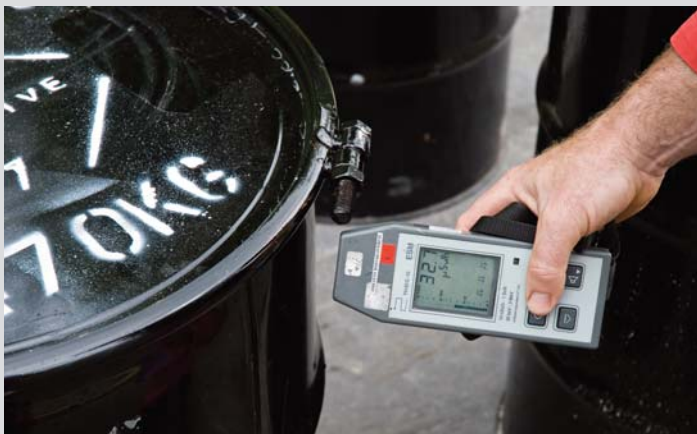
Kontrola příkonu efektivní dávky při přejímce radioaktivních odpadů.
