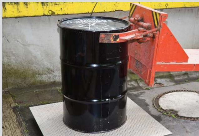
Kontrolní vážení přejímaného radioaktivního odpadu na úložiště Richard.
