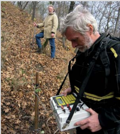
Geofyzikální měření v terénu - v rámci posouzení vhodnosti horninového prostředí vojenského újezdu Boletice k vymezení potenciálně vhodného území pro umístění hlubinného úložiště.
