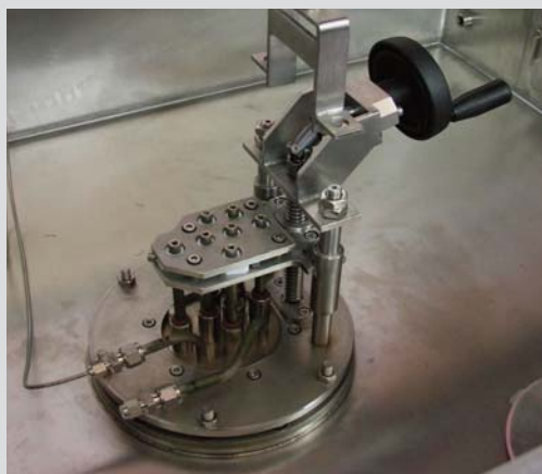
Příruba s pohyblivým systémem uchycení elektrodového souboru pro elektrochemická měření v roztavených fluoridech.
