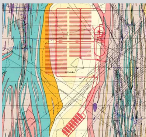
Geologická situace v úrovni 500 m pod povrchem - Kraví hora - Prostorové umístění hlubinného úložiště.
