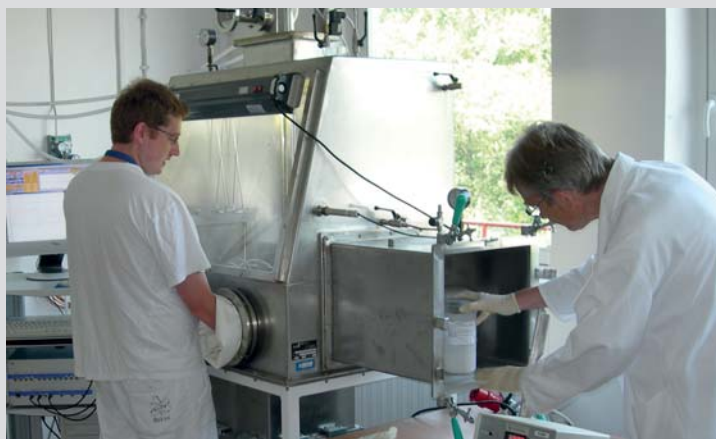
Rukavicový box s vestavěným vysokoteplotním elektrolyzérem.
