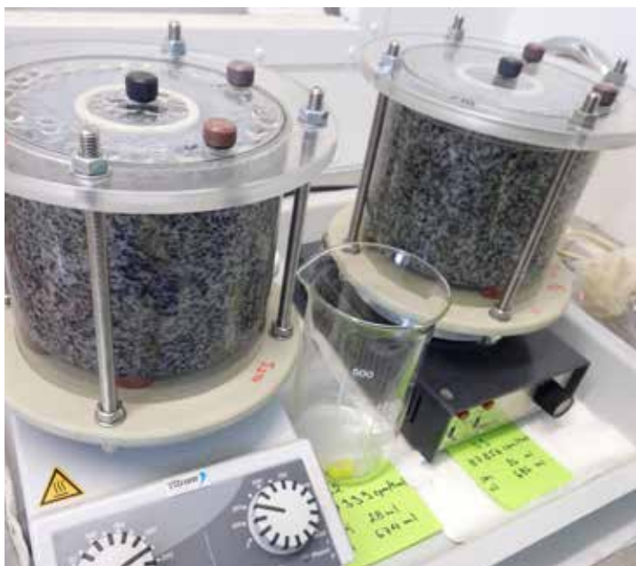
▲ Stopovací zkoušky v in-situ podmínkách (URC Josef, Mokrsko)
