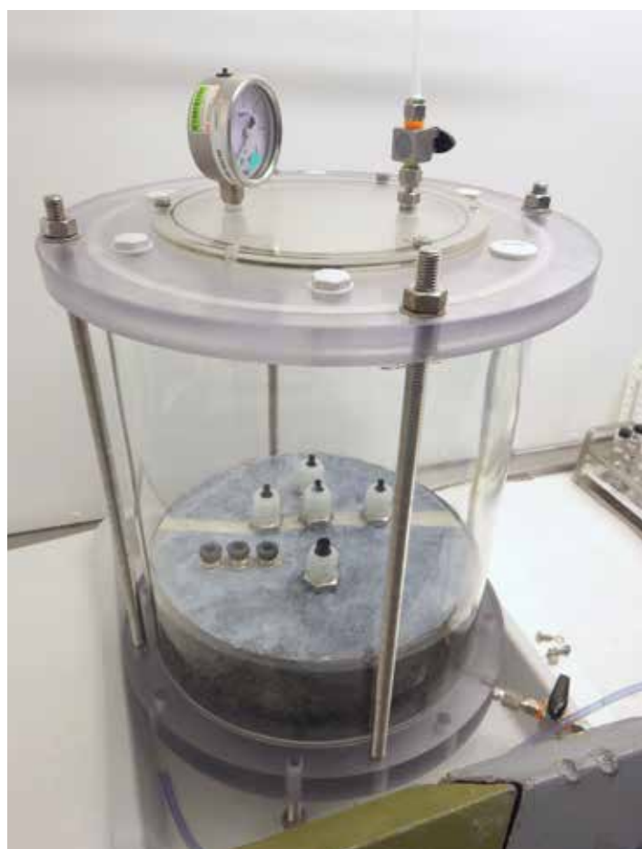
▲ Difúzní experimenty na středních vzorcích (115 mm) (obrázek vlevo dole); difúzní experimenty na vzorku (290 mm) s preferenční cestou (obrázek nahoře)
