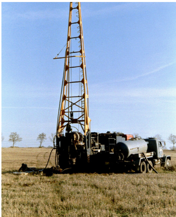
Foto 1, 2: Jádrové vrtání se soupravou ZIF 650 M s podvozkem Tatra 815, vedle V3S fekální vůz, sloužící jako zdroj vody především pro vrtný výplach.
