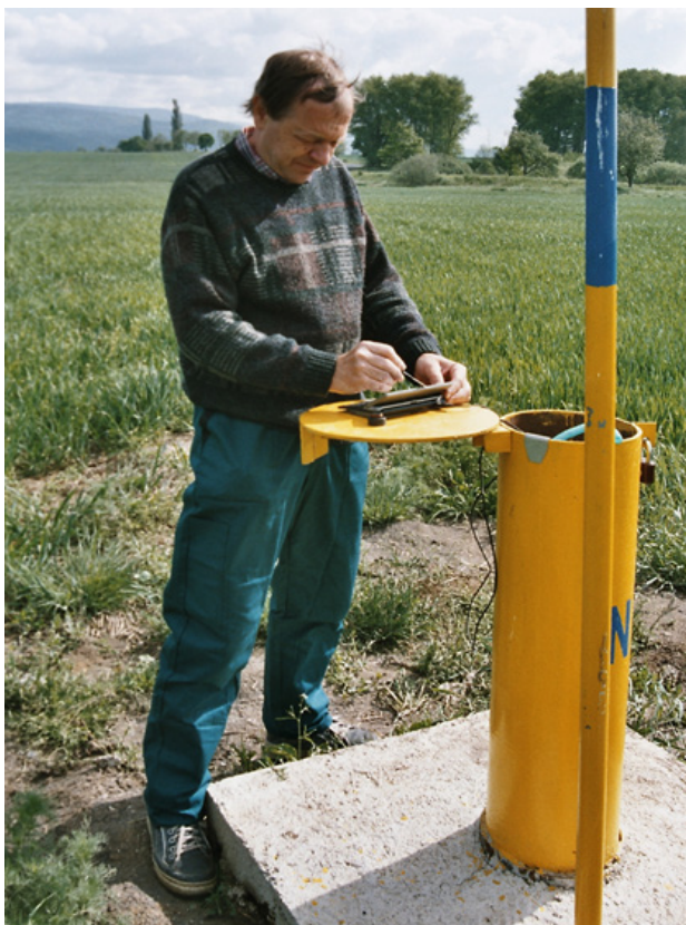
Foto 9: Sběr dat z autonomních zapisovačů – tzv. dataloggerů (měření výšky hladiny a teploty podzemní vody). M. Hercík (ÚJV Řež, a.s.).
