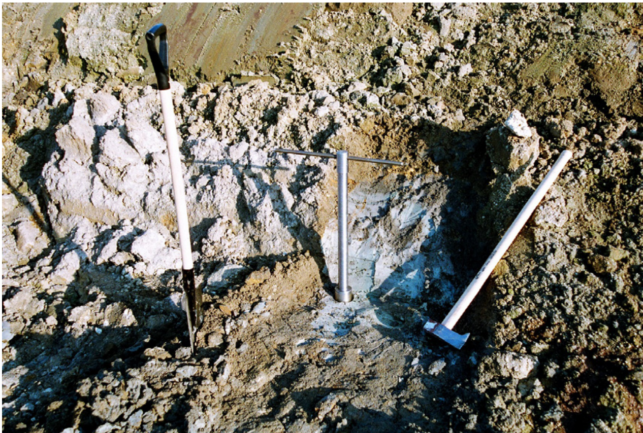
Foto 4: Odběr sedimentů z otevřeného lomu na kaolín pomocí ručního odběráku.
