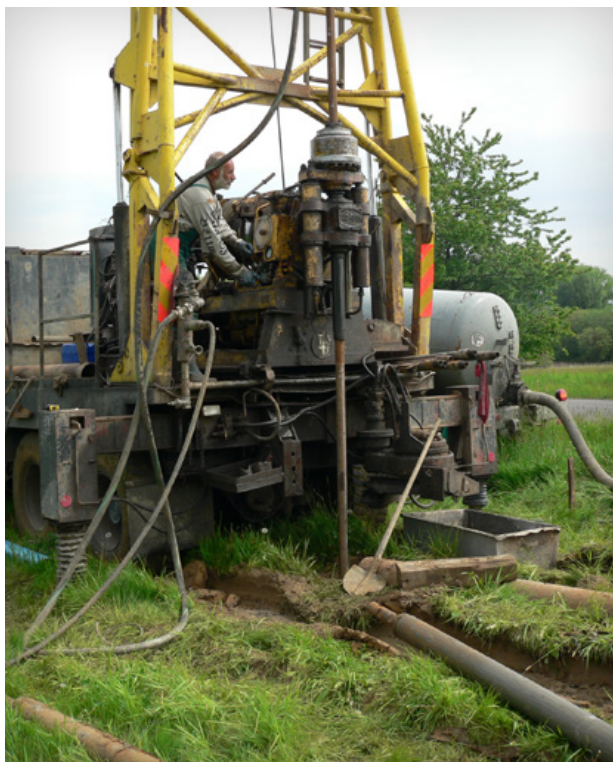
Foto 1, 2: Jádrové vrtání se soupravou ZIF 650 M s podvozkem Tatra 815, vedle V3S fekální vůz, sloužící jako zdroj vody především pro vrtný výplach.
