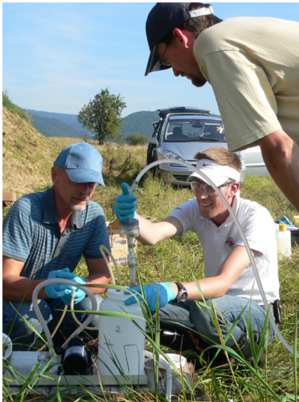
Foto 6: Odběr vzorků podzemních vod, aparatura pro separaci U(IV) a U(VI), zleva J. Suksi, K. Kaksonen (Univerzita Helsinky) a R. Červinka (ÚJV Řež, a.s.).
