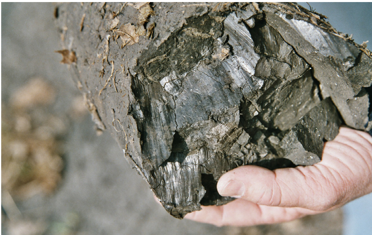
Foto 5: Odběr vzorků z vrtných jader s obsahem organické hmoty – špatně prouhelněné uhlí.
