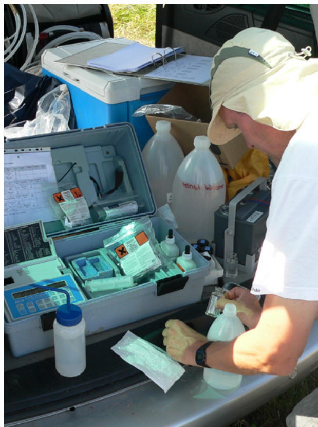
Foto 10: Měření specií železa a síry v podzemních vodách pomocí přenosného UV-VIS spektrofotometru. U. Noseck (GRS).
