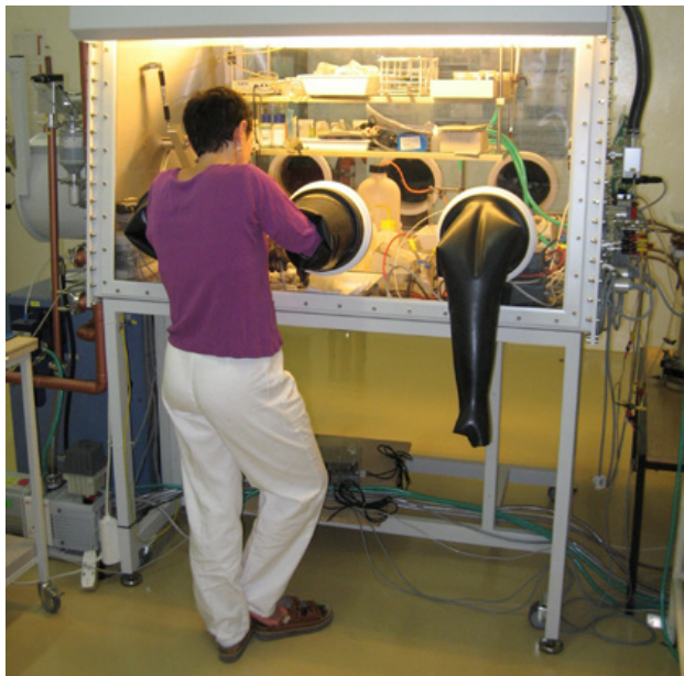
Foto 12: Práce se vzorky v rukavicovém boxu v anaerobní atmosféře (bez kyslíku). V. Havlová (ÚJV Řež, a.s.).
