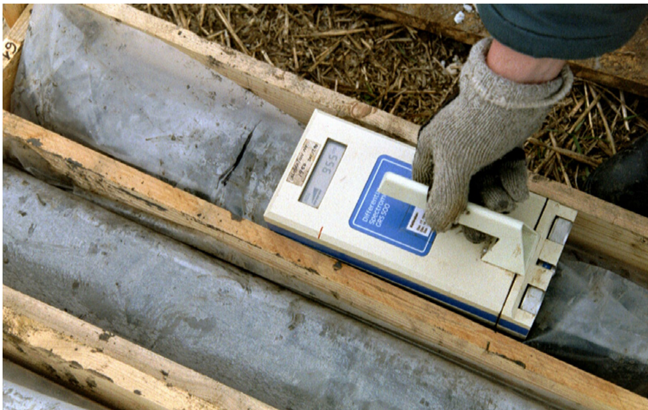
Foto 8: Měření gama aktivity jádra terénním gamaspektrometrem.
