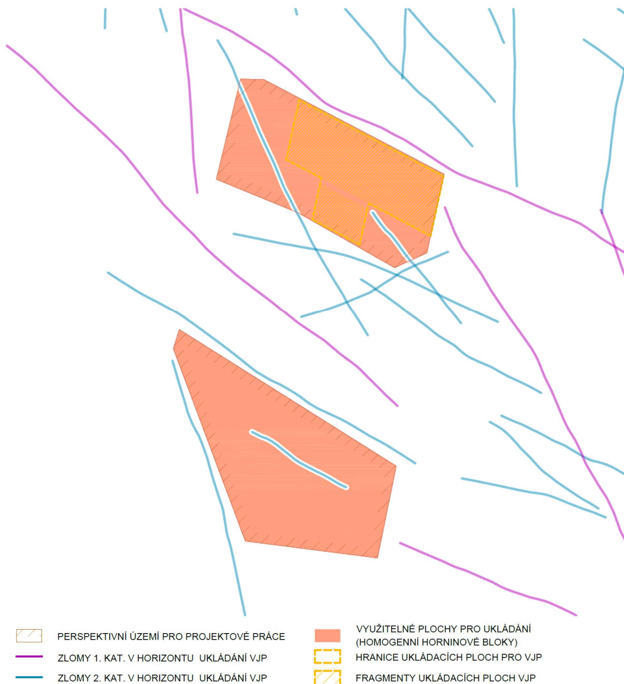
Obr. 1 – Využitelnost horninových bloků – lokalita Březový potok
