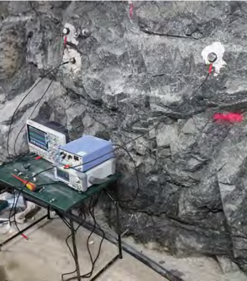
Testování zařízení pro seismická měření na PVP Bukov
