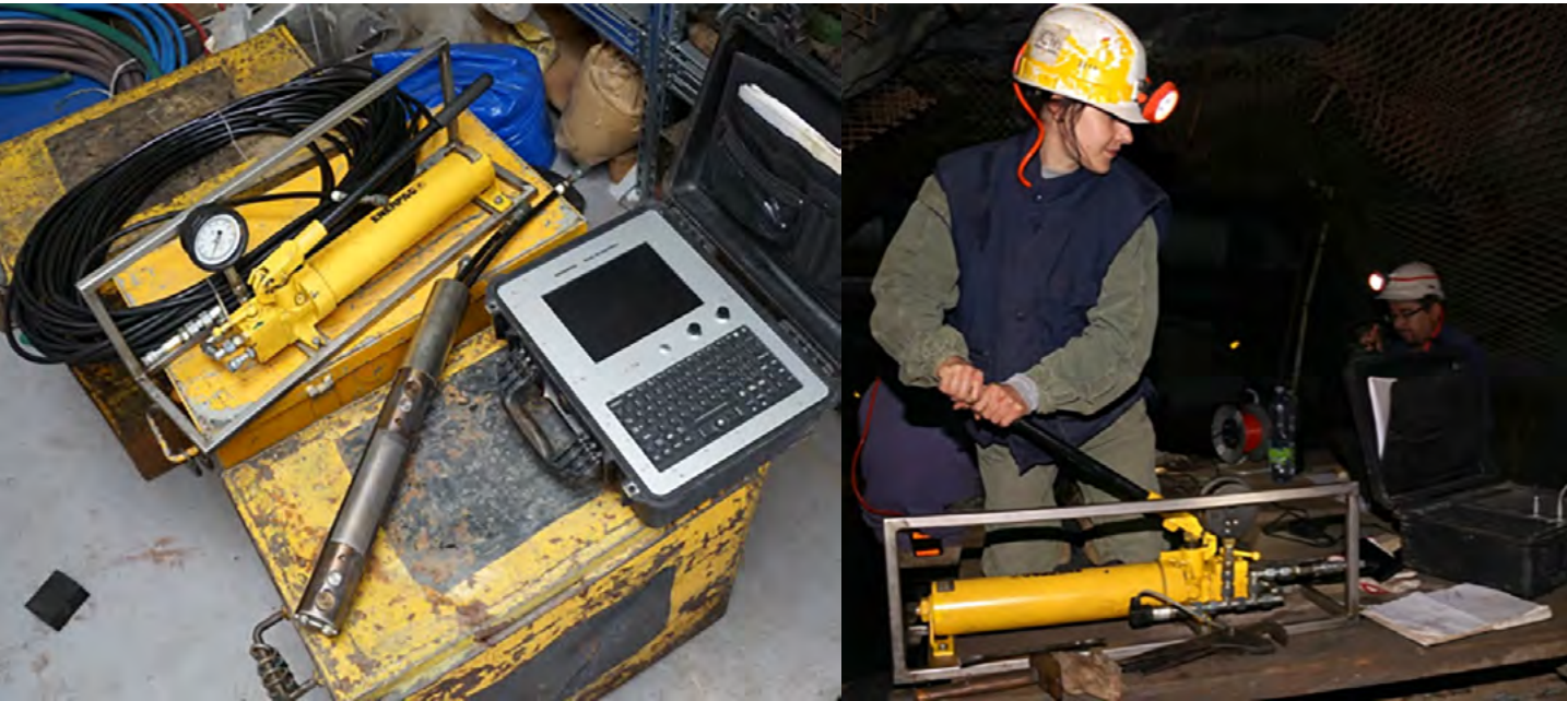
↑ Zařízení pro měření přetvárných vlastností hornin Goodman Jack
