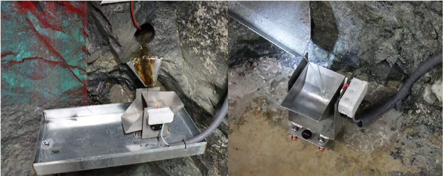
↑ Systém pro měření přítoků vod do PVP Bukov pomocí překlopných člunků
