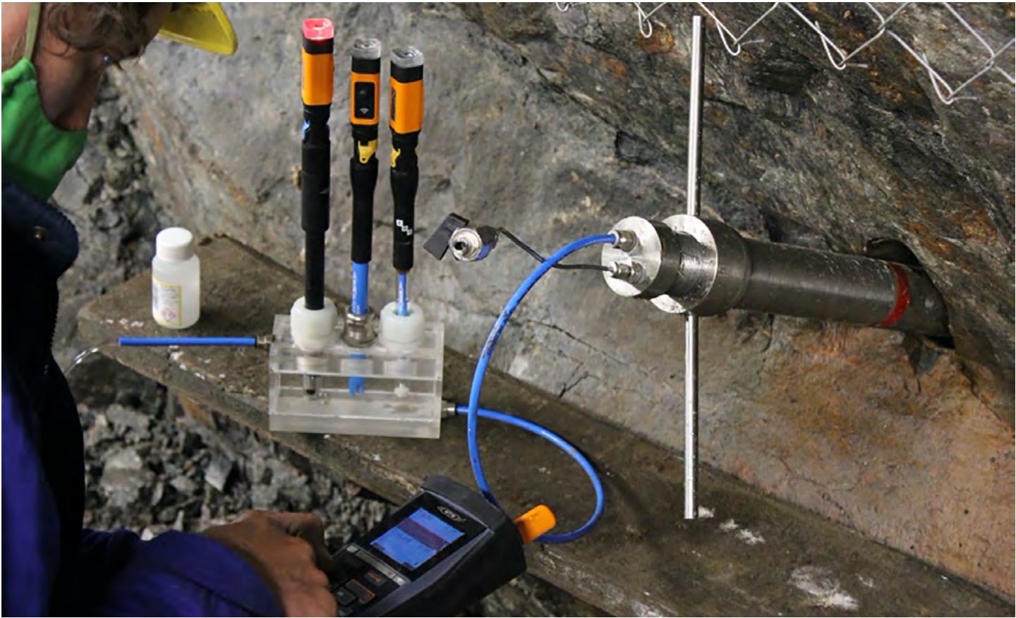
↑ Geochemická měření v pilotním vrtu S-27
