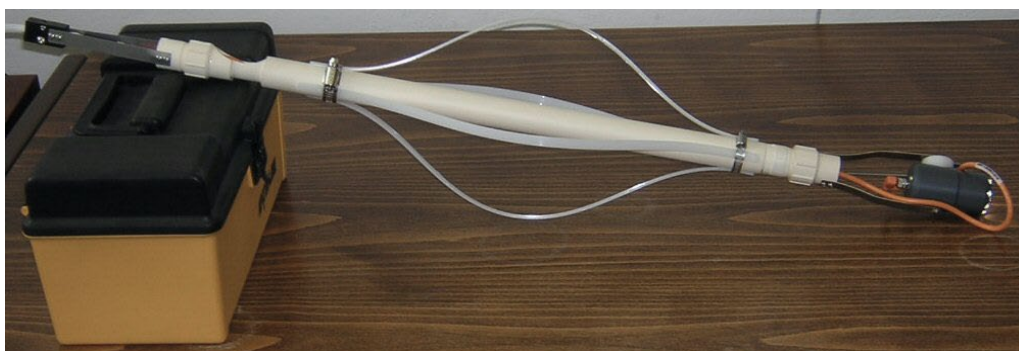
Obr. 8 Vlastní hlubinná sonda televizní kamery Geovision
