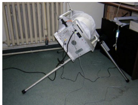
Obr. 10 Vrátek vrtné kamery Geovision
