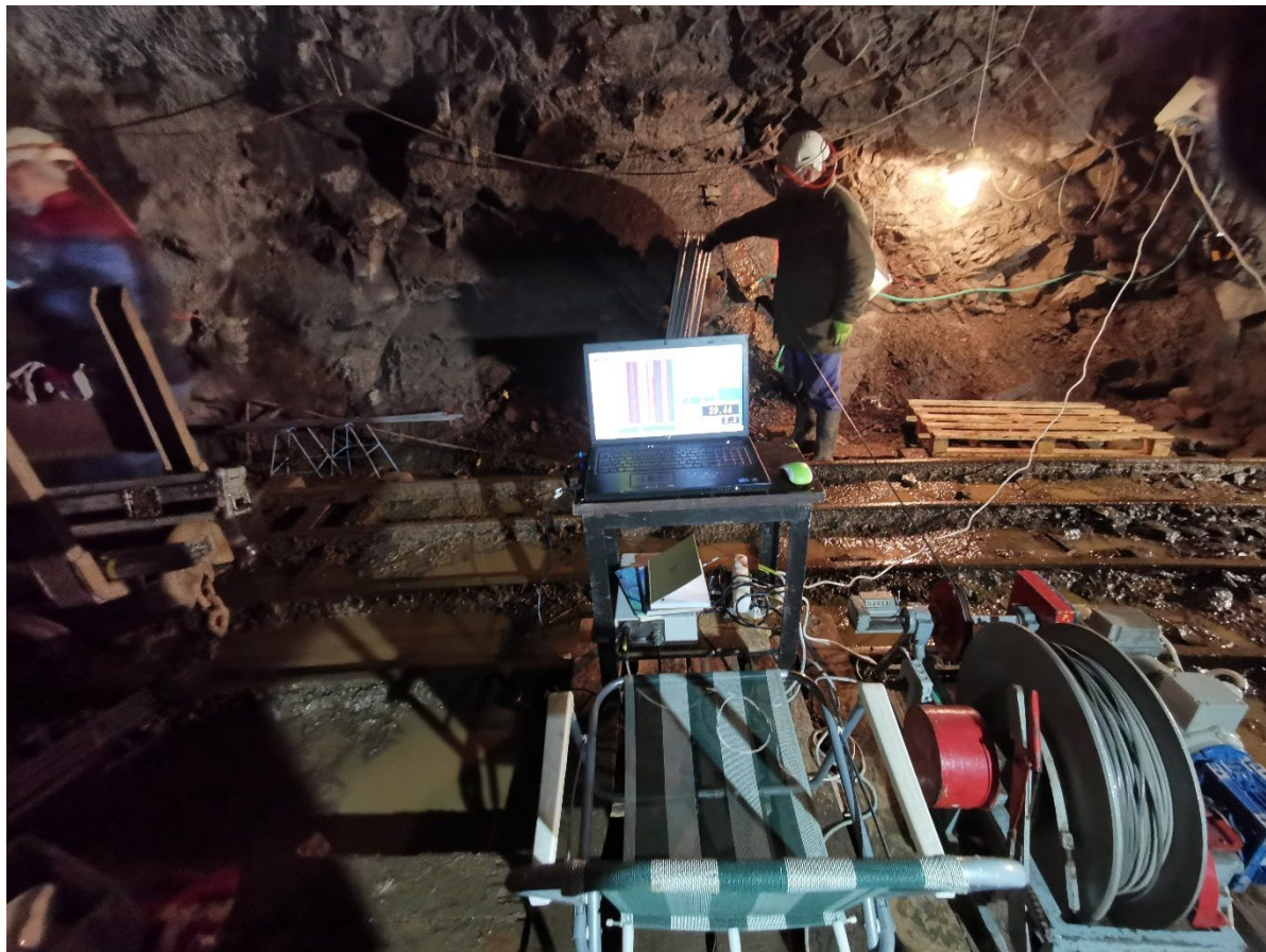
Obr. 4 Užitá měřicí jednotka Matrix (ALT Luxemburg) s příslušenstvím
