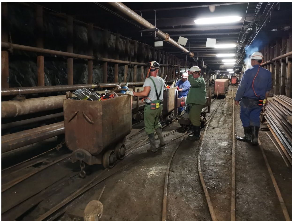
Obr. 3 Doprava karotážní aparatury na pracoviště (vrty S-24 a S-33)
