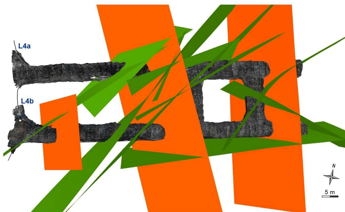
Obr. 31 Půdorys 3D strukturního modelu zlomové sítě severní části PVP Bukov II. Zelené plochy představují poruchové zóny a oranžové plochy představují zóny křehce reaktivované metamorfní foliace.
