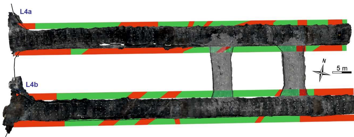
Obr. 35 3D vizualizace celkových výsledků druhé fáze II. stupně hodnocení stěn laboratorních chodeb. Zelená barva reprezentuje úseky klasifikované jako vhodné a červená jako nevhodné.
