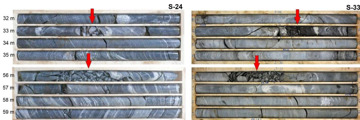
Obr. 23 Ukázka kritických struktur identifikovaných na vrtných jádrech
