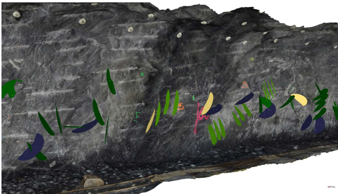
Obr. 9 Fotogrammetrický 3D model stěny ukládací chodby s dokumentovanými strukturními prvky reprezentovanými diskovými plochami. Zelené – pukliny, žluté – poruchové zóny/zlomy, modré – metamorfnní foliace
