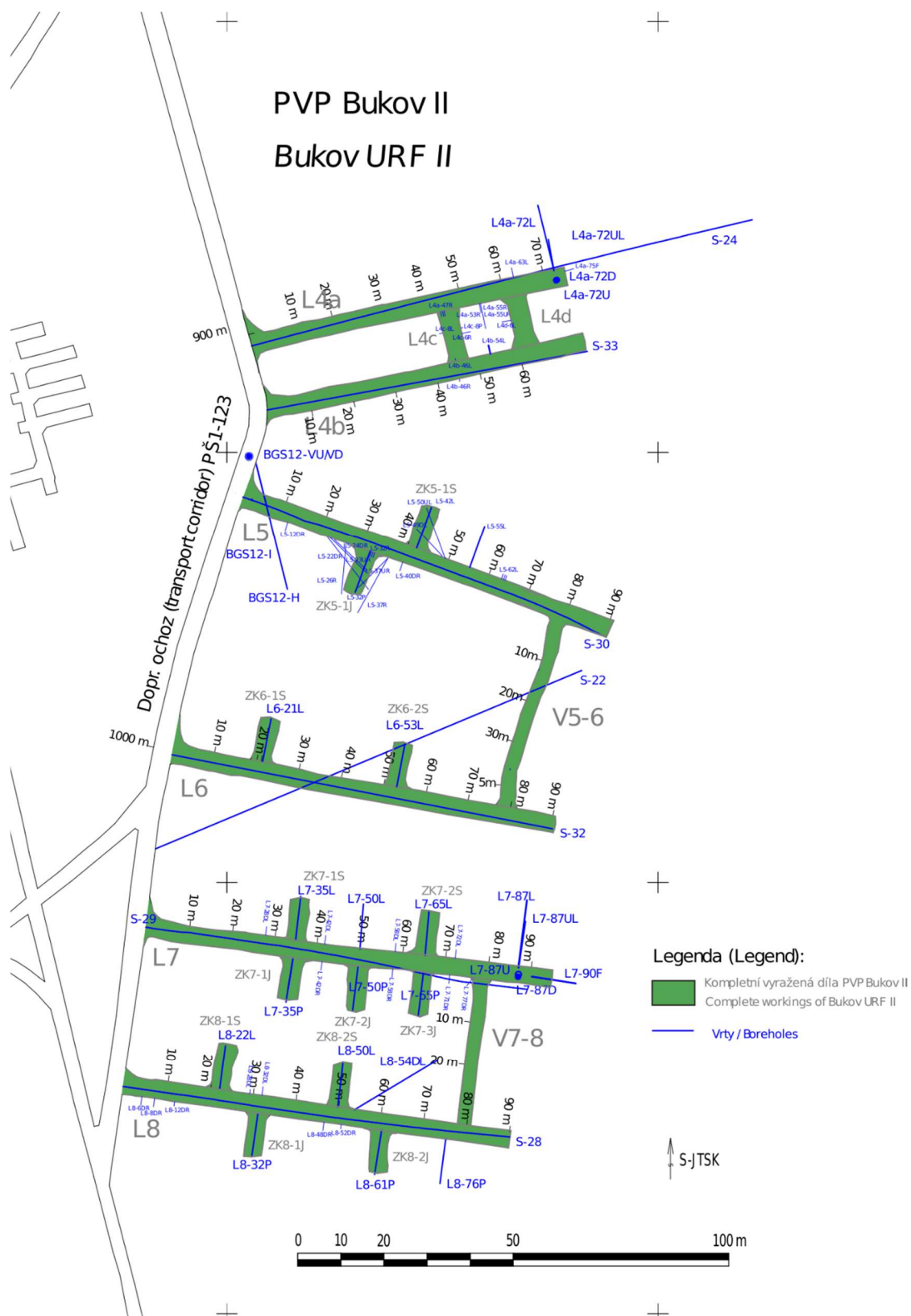
Obr. 3 Finální rozsah PVP Bukov II k začátku roku 2025 – vyznačení vyražených a dokumentovaných prostor po dobu řešení projektu včetně průběhu realizovaných vrtů na PVP Bukov II (zdroj: SÚRAO)
