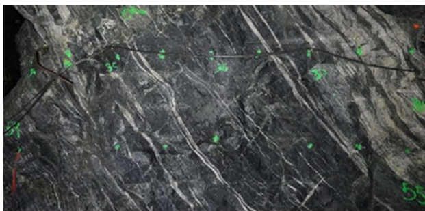
Obr. 9 Biotitický migmatit se stromatitickou texturou
