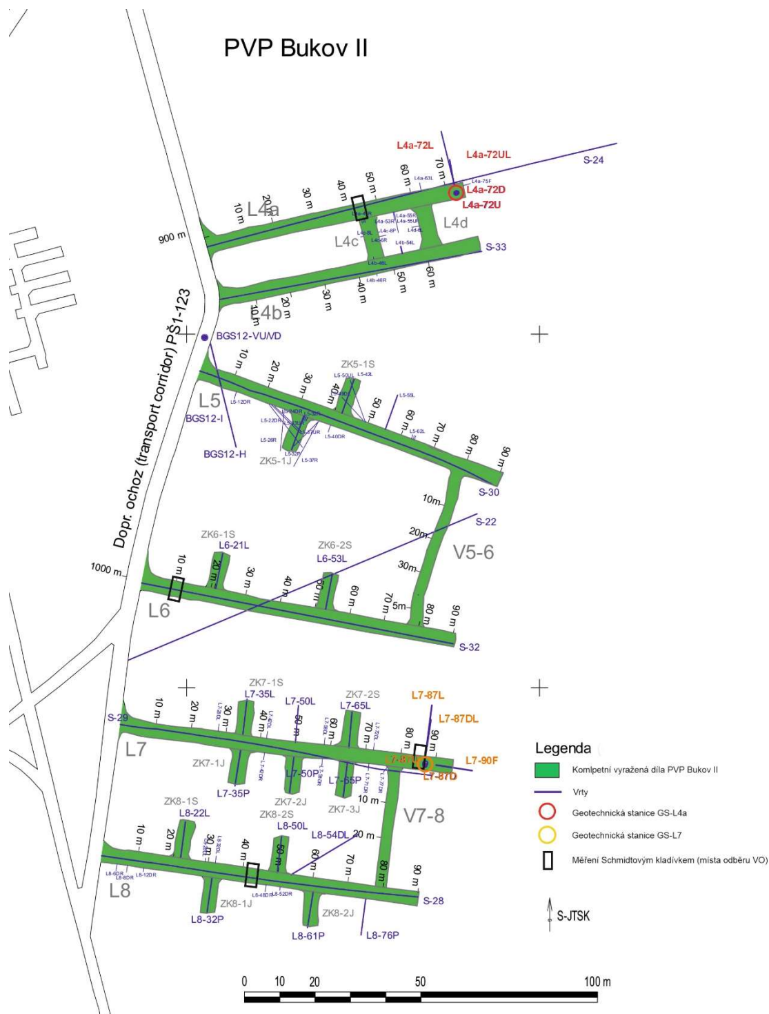
Obr. 24 Lokalizace geotechnických stanic GS-L7 a GS-L4a s označením geotechnických vrtů včetně znázornění míst měření Schmidovým kladívkem
