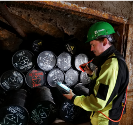
Kontrola nepropustnosti obalových souborů dozimetrem
