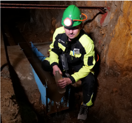
Odebírání vzorku vody v úložišti
