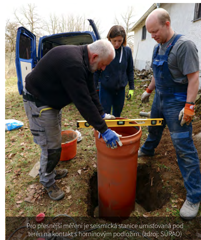
Bezpečné umístění seismické stanice v dobrém kontaktu s podložím (zdroj: SÚRAO)
